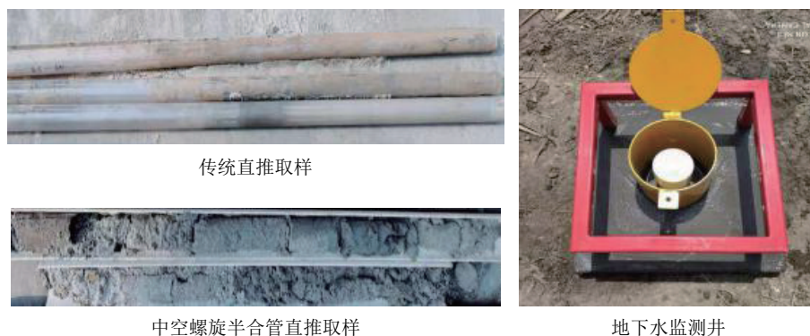
图5 组合工艺取样效果对比及建井情况
