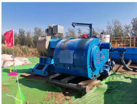
图1 F-1300型永磁直驱泥浆泵在雄安地热钻井应用现场
