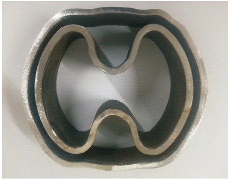
图9 水力膨胀前后波纹管截面对比图
