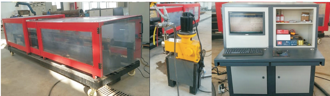
图5 可膨胀波纹管水力膨胀试验系统
