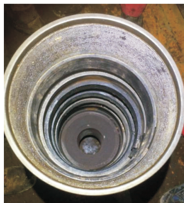
图 2 LT-T206 型卡瓦打捞筒
