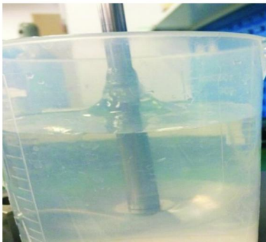
图2 PAM溶液搅动产生的爬杆现象
