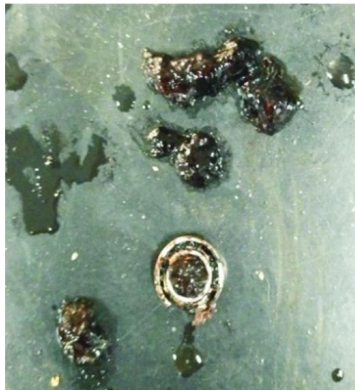
图9 小轴承被腐蚀
