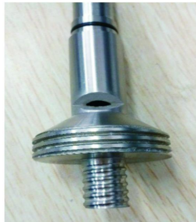
图14 螺旋防爬杆结构实物
