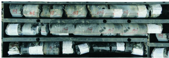
图3 YZX108液动锤钻进获取的岩心
