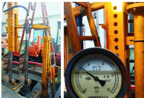
图2 YZX108型液动锤室内调试
