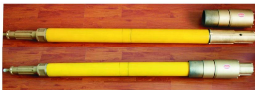
图3 空气潜孔锤跟管取心钻具
