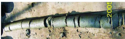
图4 空气潜孔锤跟管取心钻具取出的岩心
