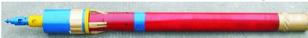
图 4 套管取心钻具及装配图
