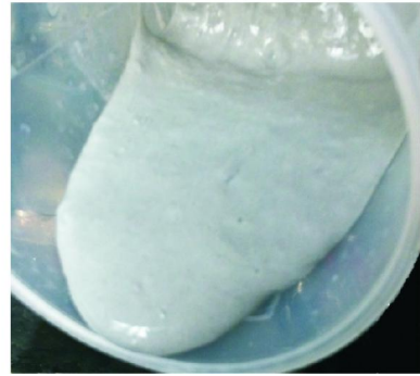
图 5 GN-1 凝胶加重至 1.6 \text{ g/cm}^3 (重晶石加重) 地面预交联状态
