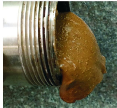
图 6 GN-1 凝胶加重至 1.6 \text{ g/cm}^3 (重晶石加重) 180 °C 老化 24 h 后状态
