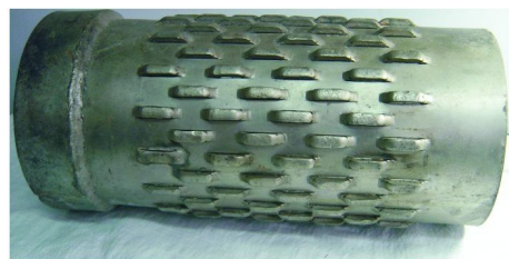
(a) 浸水试验前镀锌过滤管
