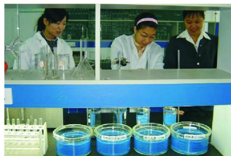
图4 PVC在不同水质中腐蚀结垢试验
