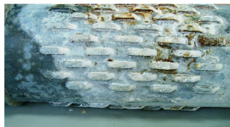
(b) 浸水30 d时腐蚀结垢情况
