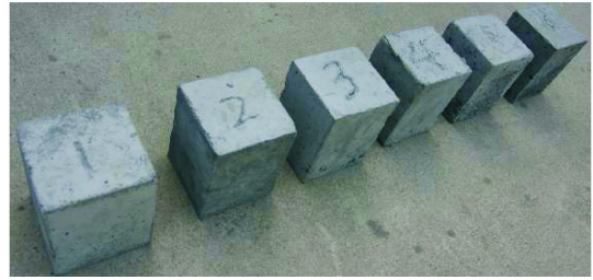
图1 煤岩相似材料试样
