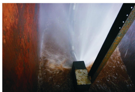
图 5 喷射破岩试验
