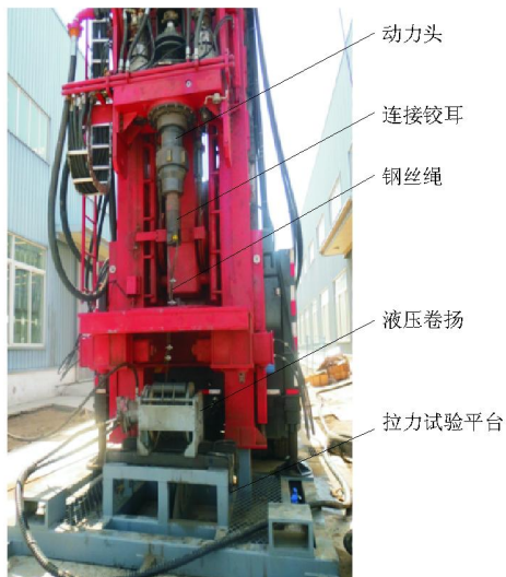
图6 动载稳定性试验
