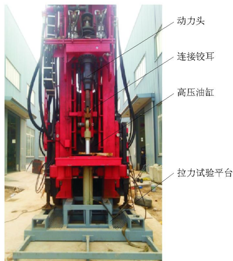
图5 静载负荷试验
