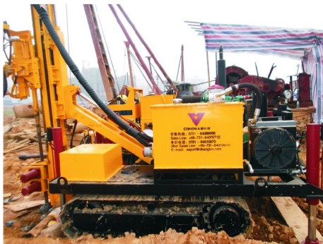
图4 普通回转钻进工艺
