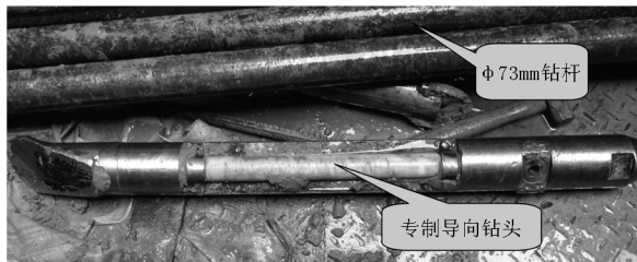
图2 \phi 73 mm 钻杆及专制导向钻头
