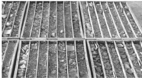
图 1 矿区典型破碎蚀变带岩心
