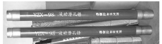
图 2 三合一钻具用液动潜孔锤
