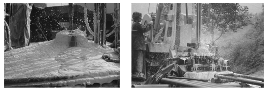
图7 散装和车装转盘钻机注入泡沫剂钻进现场
