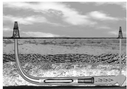
(b) 可溶性矿产开采对接井工程
